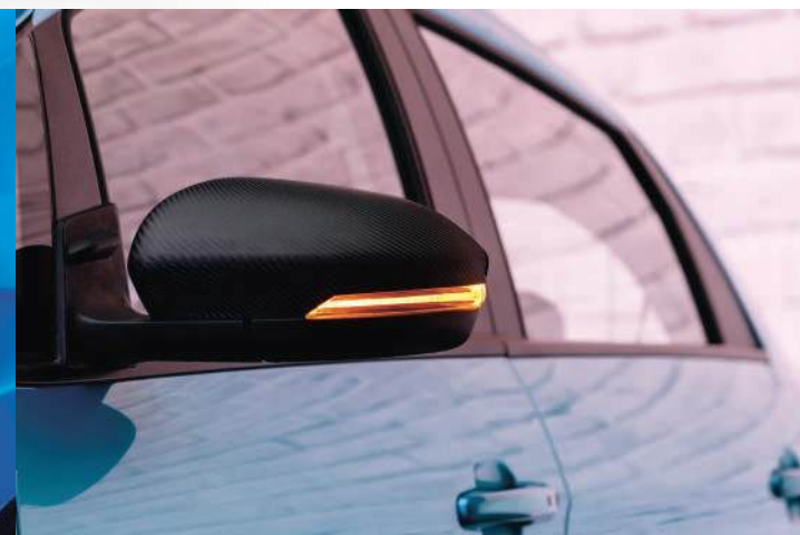
Rétroviseurs extérieurs avec clignotants LED
